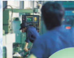
商品の金型を作るマシ ニングセンター。高 品質の製品は精度の 高い金型が絶対条 件だ。
